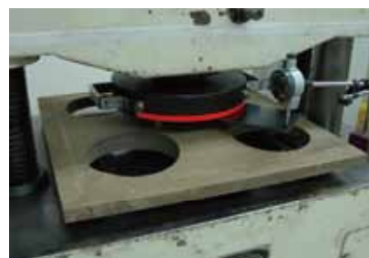
室内載荷試験状況
