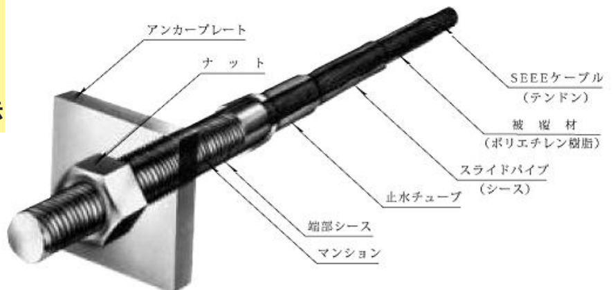
<SEEE永久グラウンドアンカー工法の頭部詳細>
