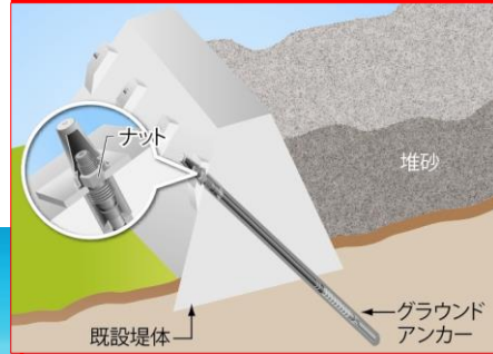
【砂防堰堤補強アンカー】
