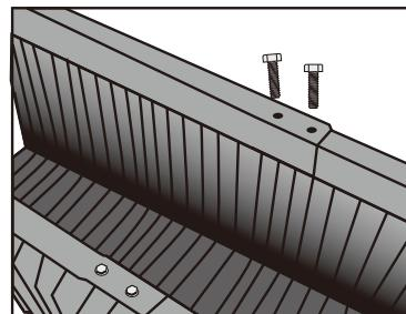
③接続部をボルトで締付ける
