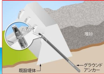
【砂防堰堤補強アンカー】
